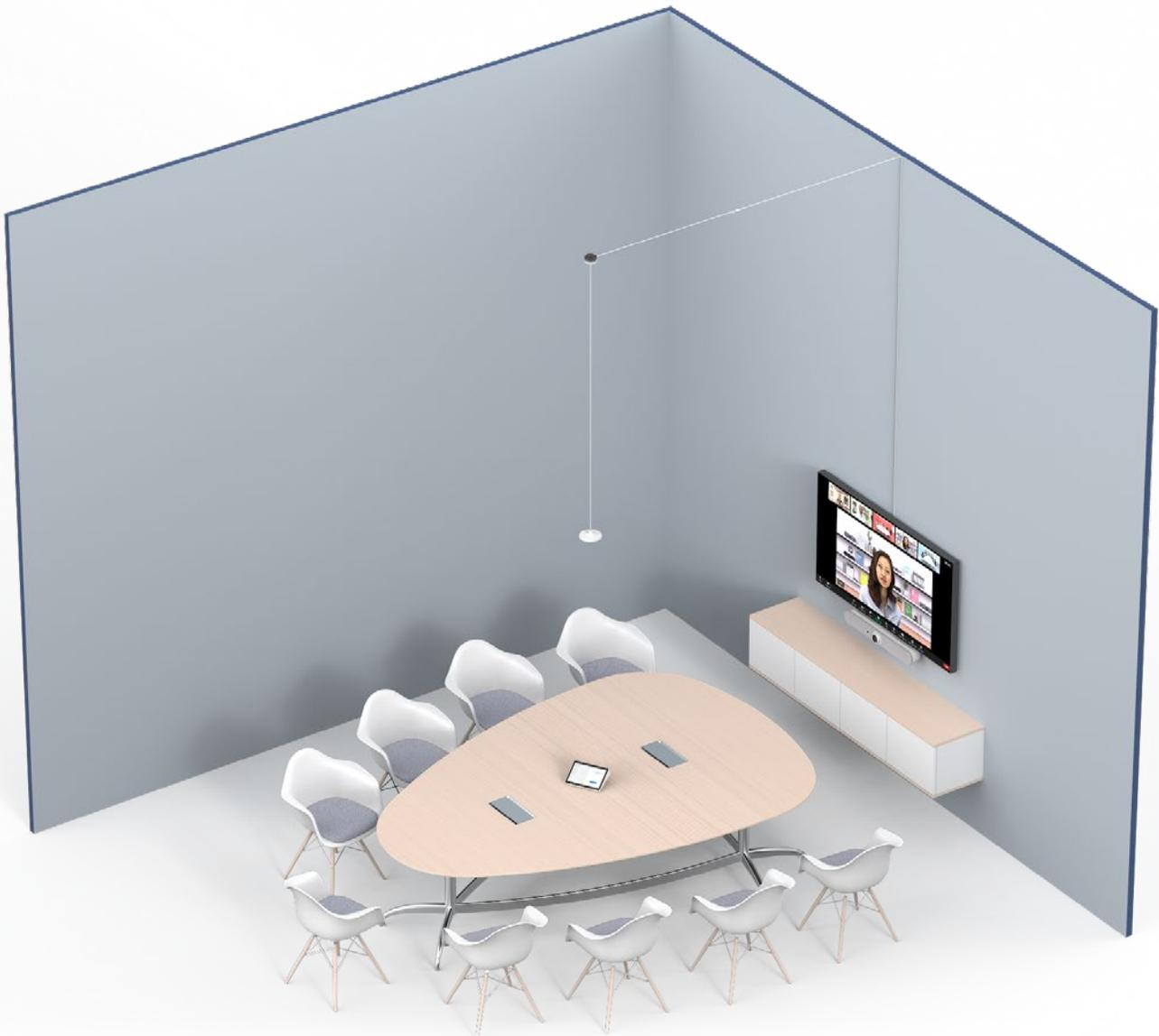
Abbildung 1: Mic Pod mit Hängehalterung. In dieser Abbildung ist das Mic Pod Kabel mit einem Mic Pod Verlängerungskabel verbunden, das an Rally Bar Mini unter dem Fernseher angeschlossen ist. Hinweis: Abbildung nicht maßstabsgetreu.
